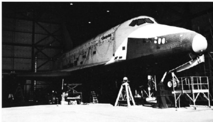
Figura 2.2.2 – Teste dinâmico realizado no ônibus espacial Enterprise (Rao, 2011).
